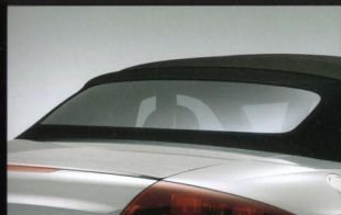
電動ソフトトップ/ガラス製リヤウインドー (TT Roadster 2.0 TFSI)
