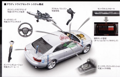
ダイナミックスタアリングシステム 運転状況に応じて、スタアリング比とスタアア角を最適に調整。車体変更や コーナリング、パーキング時などの快適性とハンドリング性能を向上させます。
