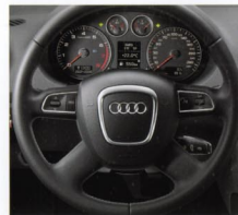
マルチファンクションスイッチ付本革巻き4スポークステアリングホイール【オプション】
